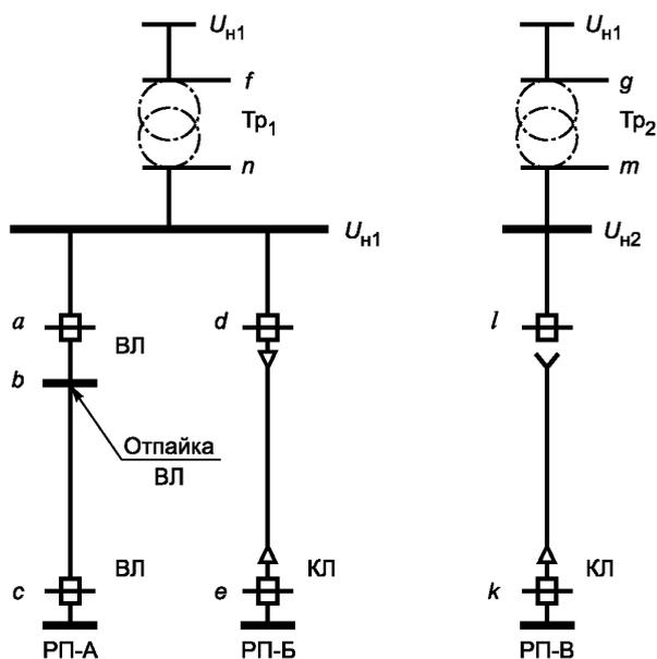
ВЛ - воздушная линия; КЛ - кабельная линия; РП-А, РП-Б, РП-В - распределительные подстанции;  $Tr_1$ ,  $Tr_2$  - силовые трансформаторы;  $U_{н1}$ ,  $U_{н2}$  - напряжения на первичной и вторичной обмотках силового трансформатора; a, b, c, d, e, f, g, k, l, m, n - возможные точки присоединения к электрической сети
